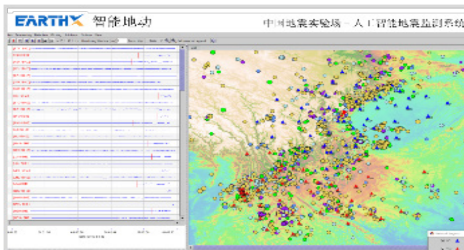
图 1 中国科大交叉合作团队与中国地震局合作推出的人工智能地震实时监测系统。红色三角符号代表云南省境内地震台，蓝色三角符号代表四川省境内地震台，圆圈是该系统自动报出的地震位置。
