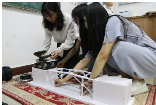
图为参赛人员正在进行纸桥承重测试
